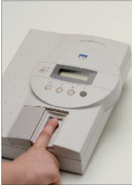
Prototyp des ersten unblutigen Blutzucker- messgerätes (z.Z. in der Wanderausstellung)
